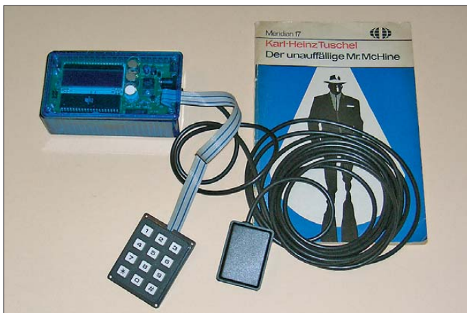
Bild 1: Beim Versuchsaufbau des Codeschlusses wurde eine ähnliche Controllerbaugruppe verwendet.
