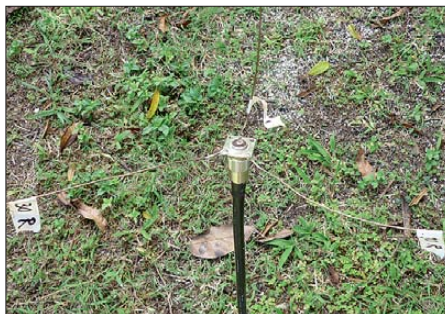
Einfach und effektiv: Einspeisung der 30-m-Vertikalantenne
