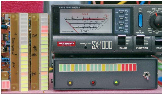
Bild 3: Ansicht der bestückten Leiterplatte mit noch nicht abgetrennter Anzeige
