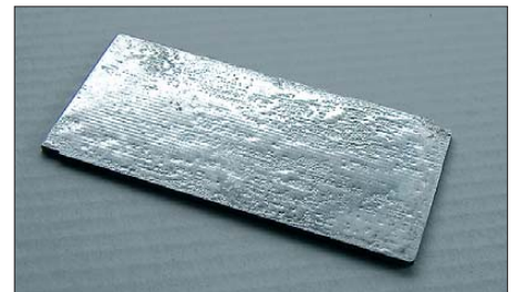
Bild 4: Auch beim Auftragen der Fittingslötpaste mit einem Pinsel ist es schwierig, große Masseflächen gleichmäßig zu verzinnen.
