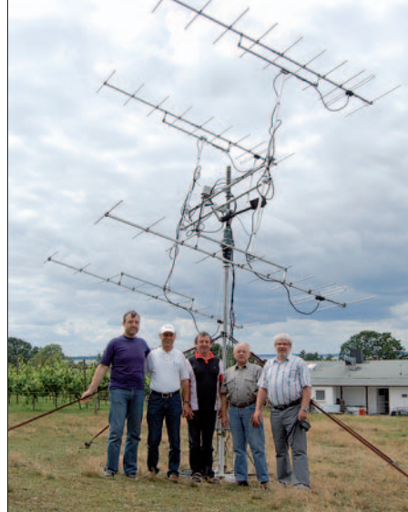
Die 4 x Zehnelement-EME-Antennengruppe, davor v. l. n. r.: DL2NTE, DL4KUG, DJ4TC, DF1AN, DK1CO
