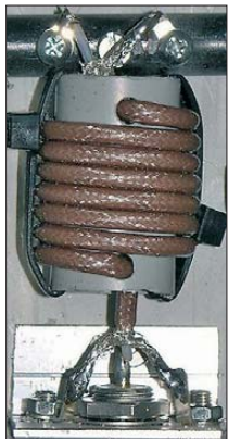
Bild 6: Speisedrossel mit 7 Wdg. sowie 25 mm Durchmesser aus Teflon-Kabel
