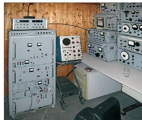
Bild 2: Rohde & Schwarz Sender SK1 mit Empfänger EK47 und andere Geräte – hier im Einsatz für den Kurzwellen-Amateurfunkbetrieb
