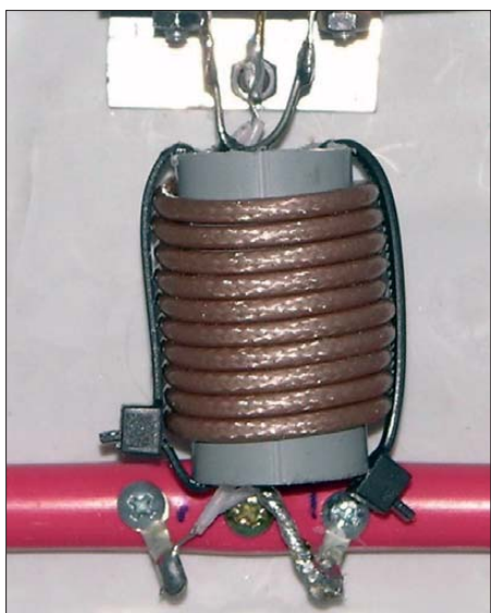
Bild 12: Auch für 2 m kann man eine Speisedrossel mit Impedanztransformation aus zwei parallelen RG179-Kabeln verwirklichen.
