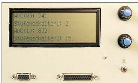
Bild 3: Realisierungsbeispiel; in der Anzeige sind die beiden von den Potenziometern und dem A/D-Umsetzer gelieferten Digitalwerte zu sehen. Das Programm errechnet daraus zwei Schalterstellungen, die zur Beeinflussung des Programmablaufes genutzt werden können. Foto: DHILD
