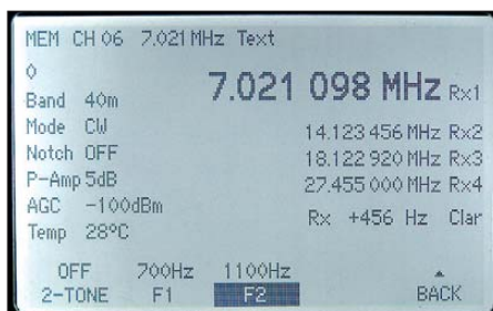
Bild 15: Das Hauptdisplay mit vier eingeschalteten VFOs; links die Statusangaben, die Null ganz oben gibt die Drehgeschwindigkeit des Abstimmknopfs an. Außerdem sind der Speicherkanal 6 gewählt, die Empfängerverstimmung eingeschaltet und die Einstellung einer Frequenz des Zweitontests am SELECT -Knopf aktiv.
