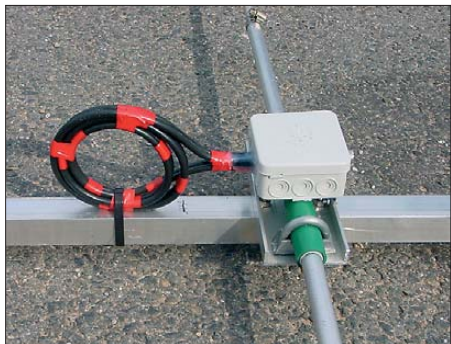
Bild 11: Eine 2 x 75-Ω-Speisedrossel für 50 MHz
