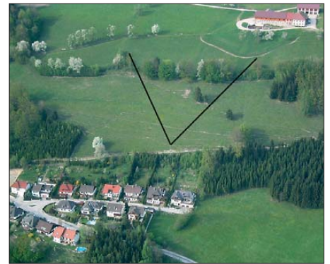
Bild 3: Standort OE3HKL mit 2 × 120-m-V-Beam (Spreizwinkel 60°, nachgezeichnet)
