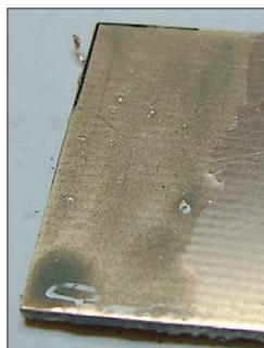
Bild 9: In einem weiteren Versuch wurde die Fittingslötpaste so stark mit Wasser verdünnt, dass sie fast durchsichtig war.
