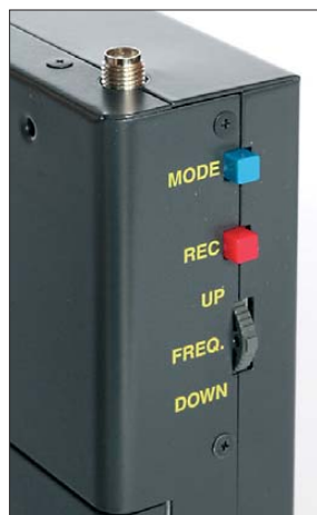
Bild 3: Bedientasten und SMA-Antennenbuchse
