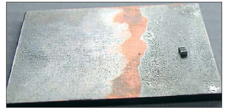
Bild 11: Je nach Verdünnungsgrad der Fittingslötpaste erhält man eine mehr oder minder körnige Zinnschicht.
