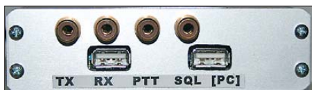
Bild 4: Gehäuserückseite des Node-Adapters
