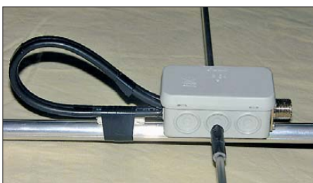
Bild 13: Korrekt ausgeführte Speisung einer 2-m-Yagi-Antenne über 75-Ω-Viertelwellenkabel
