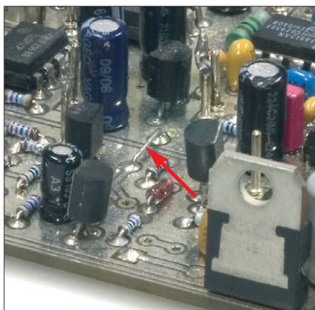
Bild 11: Lage der Drahtbrücke H Fotos: DL7LA (2), Red. FA (2)
