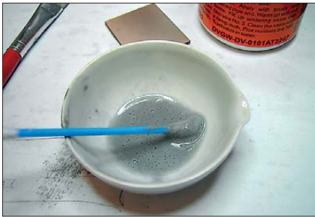
Bild 6: Zum gleichmäßigeren Auftragen wurde die Fittingslötpaste mit Wasser verdünnt.
